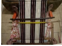
(1)安置在經軸上，用經棒固定密度與寬度。
